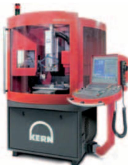
La Kern Evo est annoncée avec une précision d'usinage définie par une déviation de positionnement Pa de ± 0,5 µm selon la norme VDI/DGQ 3441. Source : Kern
