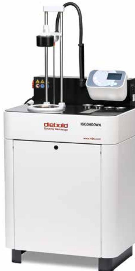
Induktiv-Schrumpfgerät mit automatischer Spulenführung und automatischer Wasserkühlung. Zum Schrumpfen von HM-Schäften Ø 3 – 20 mm und HM-Schäften Ø 6 – 20 mm. Heisse Schrumpffutter werden automatisch durch Absenken der Kühleinheit gekühlt.
