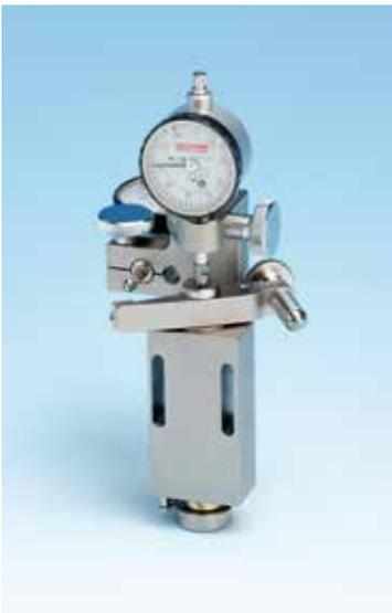
Die Messvorrichtung wird direkt am Messgerät angeschraubt. Gleichzeitig kann der Greiferrillendurchmesser  $d_6$  und der Greiferrillenabstand  $v$  geprüft werden.
