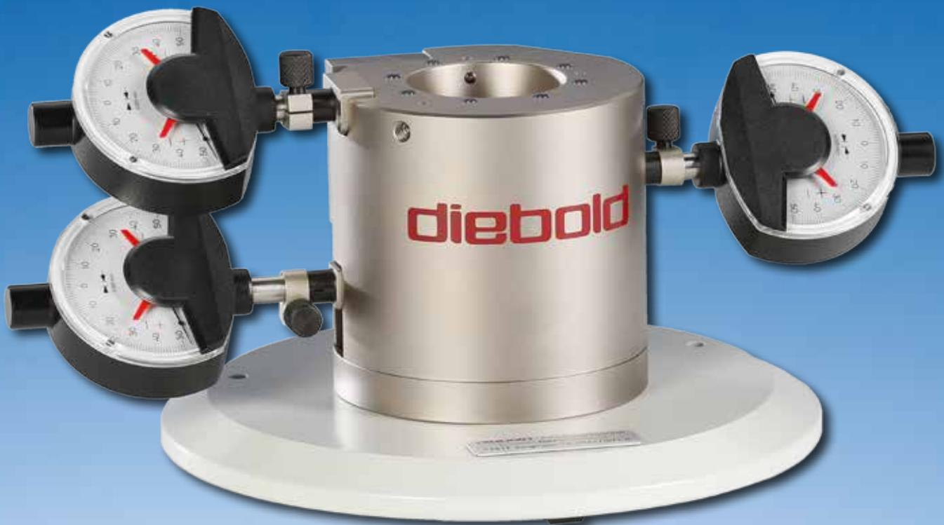
D-BT steht für Diebold-BT Kegel mit Plananlage.
